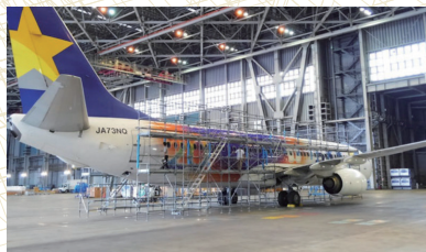
旅客機デカール貼付作業用足場
